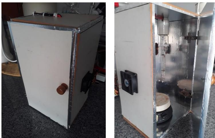
**Figura 12** - Câmara de fotodegradação equipada com lâmpada de vapor de mercúrio 400 Watts. **Fonte:** Própria.
